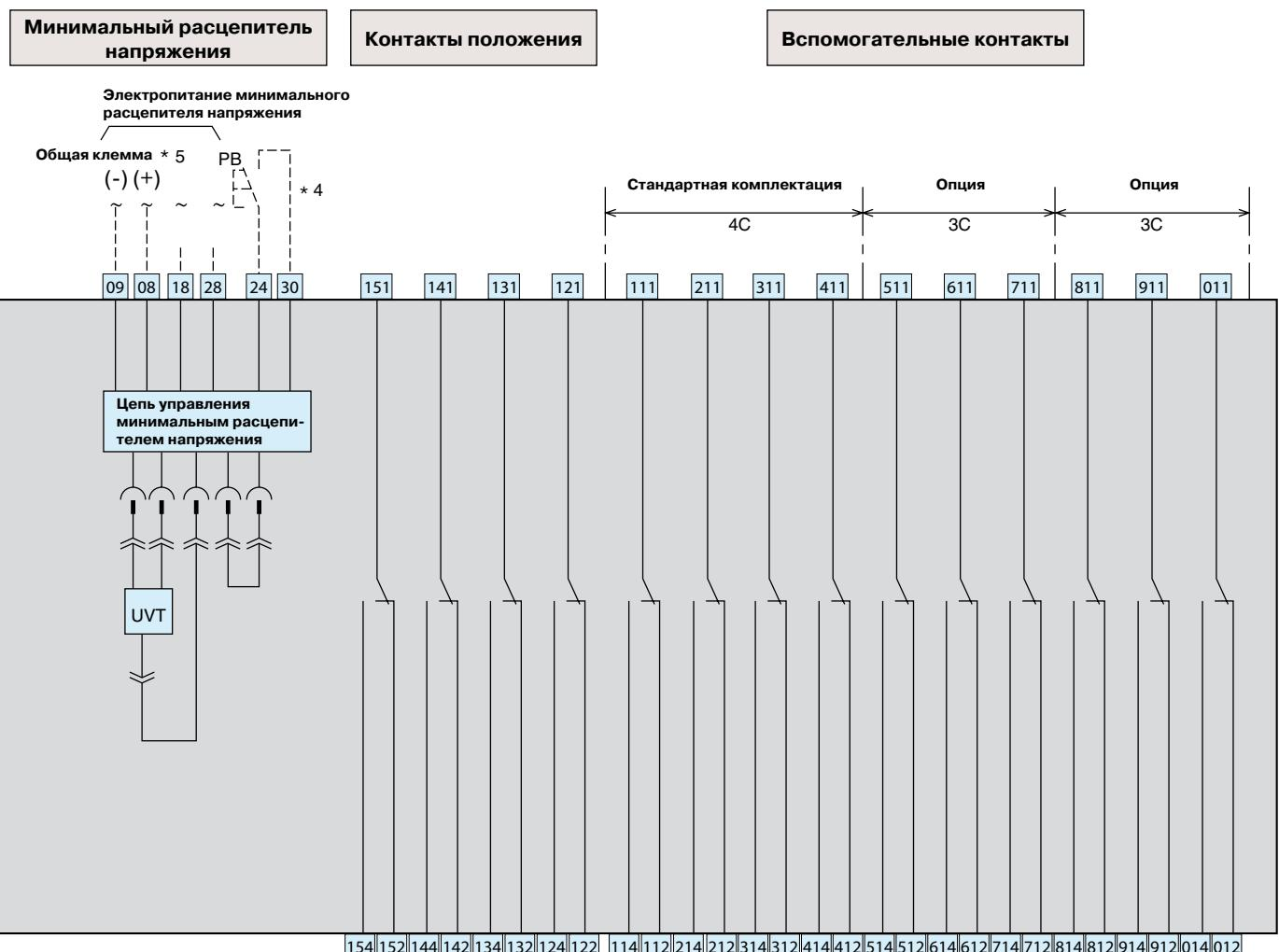
**Обозначения клемм для вспомогательных контактов и kontaktов положения**
