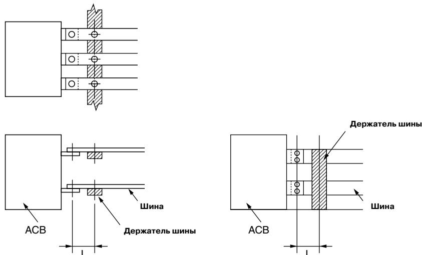
**Максимально допустимые расстояния L от первого держателя шин от места присоединения токоведущих шин к клеммам главных контактов приведены в таблице:**
