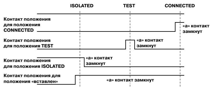
\* Положение «вставлен» (INSERT) положение означает любое положение аппарата между разъединенным (ISOLATED) и соединенным (CONNECTED)
