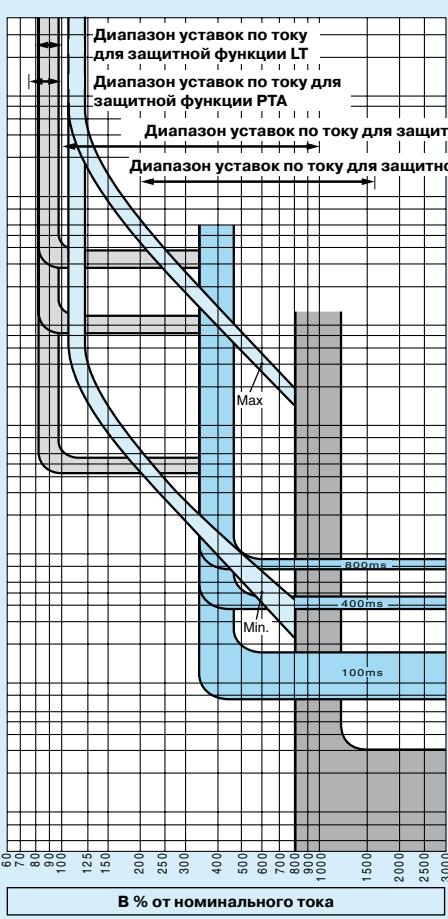
Время-токовые характеристики для защитной функции ST, показанные на данных графиках, соответствуют выключенному положению селекторного переключателя линейного вида время-токовой характеристики.
