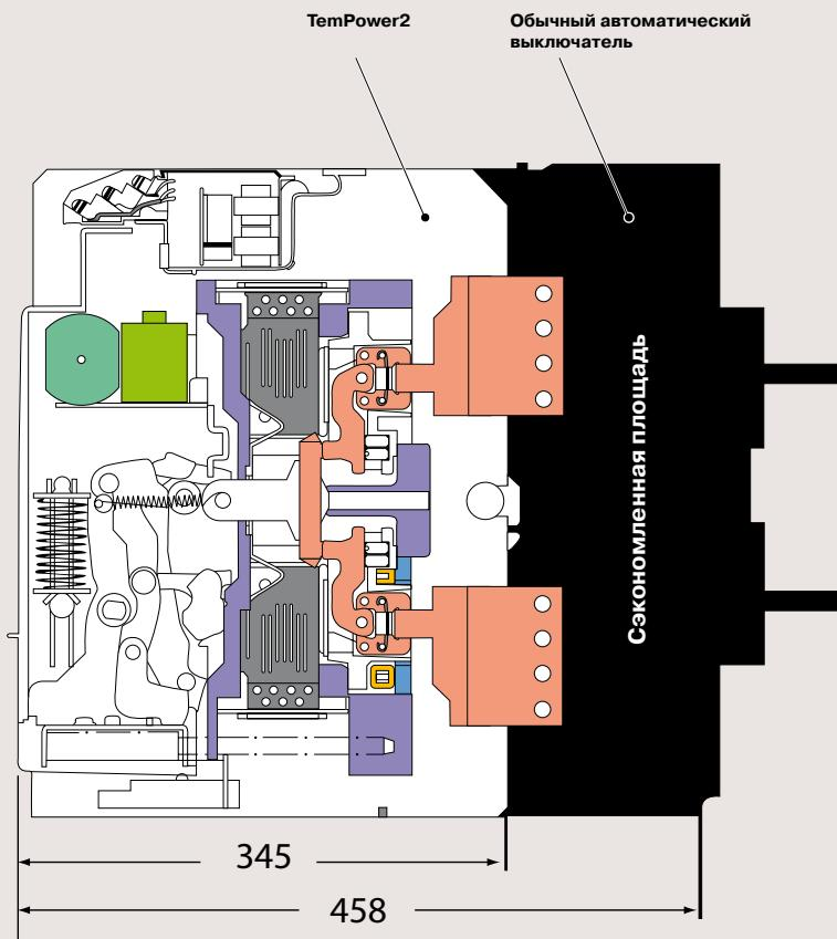
Компания Terasaki предлагает широкий ассортимент ACB серии TemPower2 номиналом от 800 до 6300 А с одинаковым размером сечения панели, что существенно облегчает монтаж таких ACB в распределительном щите. В 2008 году компания предложила новый компактный ACB AR440SB типоразмера 4000 А, а также новые ACB типа AR6 типоразмеров 5000 А и 6300 А.
