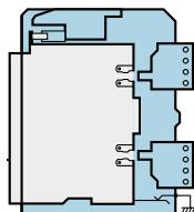
В этом положении силовая цепь разъединена, а цепи управления подключены. Тестирование ACB можно проводить при открытой двери распределительного щита.
