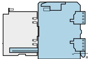
В этом положении аппарат полностью выдвинут из шасси.
