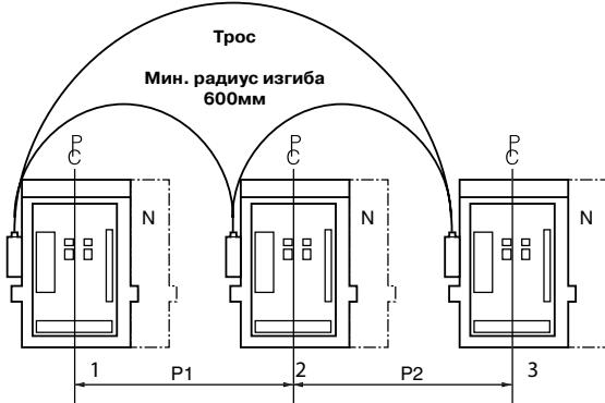
Заказывая АСВ, необходимо предварительно, пользуясь таблицей, определить расстояния Р1 и Р2 для соответствующего типа АСВ с учетом количества его полюсов.
