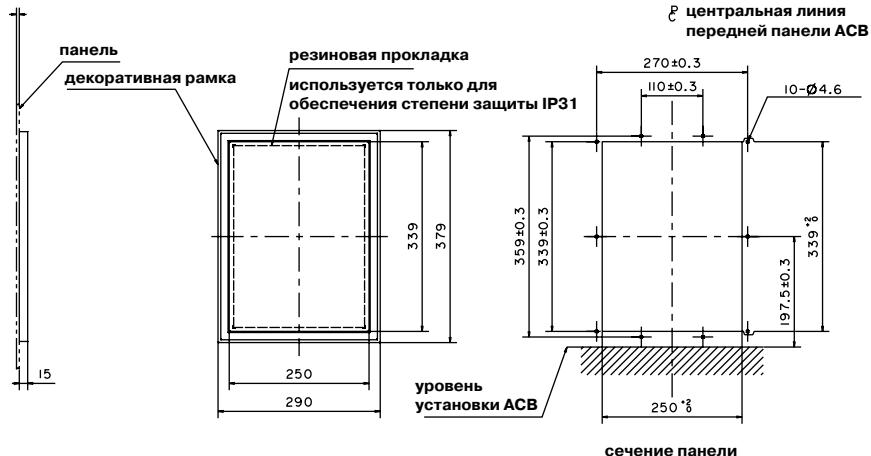
\* Закрепите декоративная рамка со степенью защиты IP20 в 6 крепежных отверстиях, а декоративная рамку со степенью защиты IP31 в 10 крепежных отверстиях.
