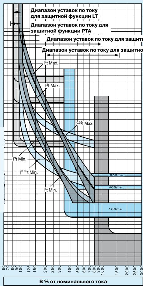
Время-токовые характеристики для защитной функции ST, показанные на данных графиках, соответствуют выключенному положению селекторного переключателя линейного вида времязадающей характеристики.
