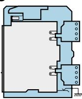
В этом положении силовая цепь и цепи управления ACB соединены с внешними цепями для нормальной работы.
