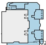
В этом положении и силовая цепь и цепи управления разъединены. Двери распределительного щита могут быть закрыты.
