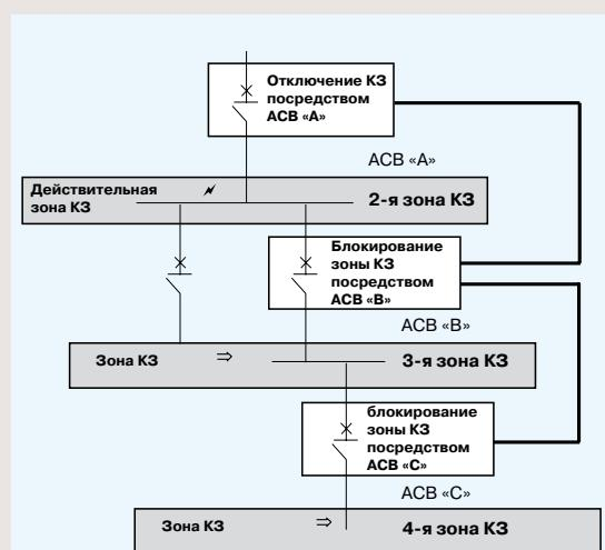
Принцип действия функции блокирования зоны короткого замыкания
