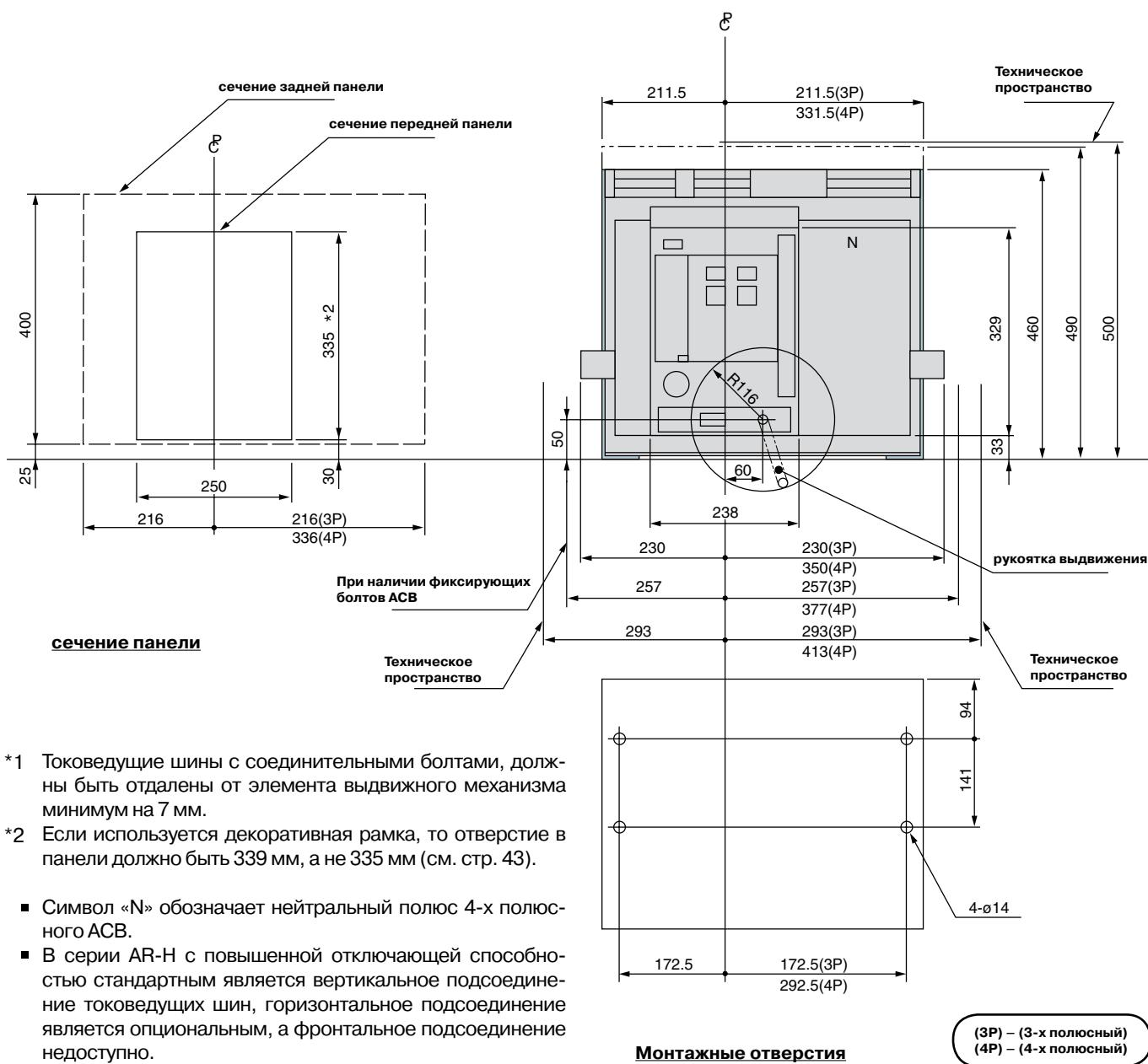
\*1 Токоведущие шины с соединительными болтами, должны быть отдалены от элемента выдвижного механизма минимум на 7 мм.
