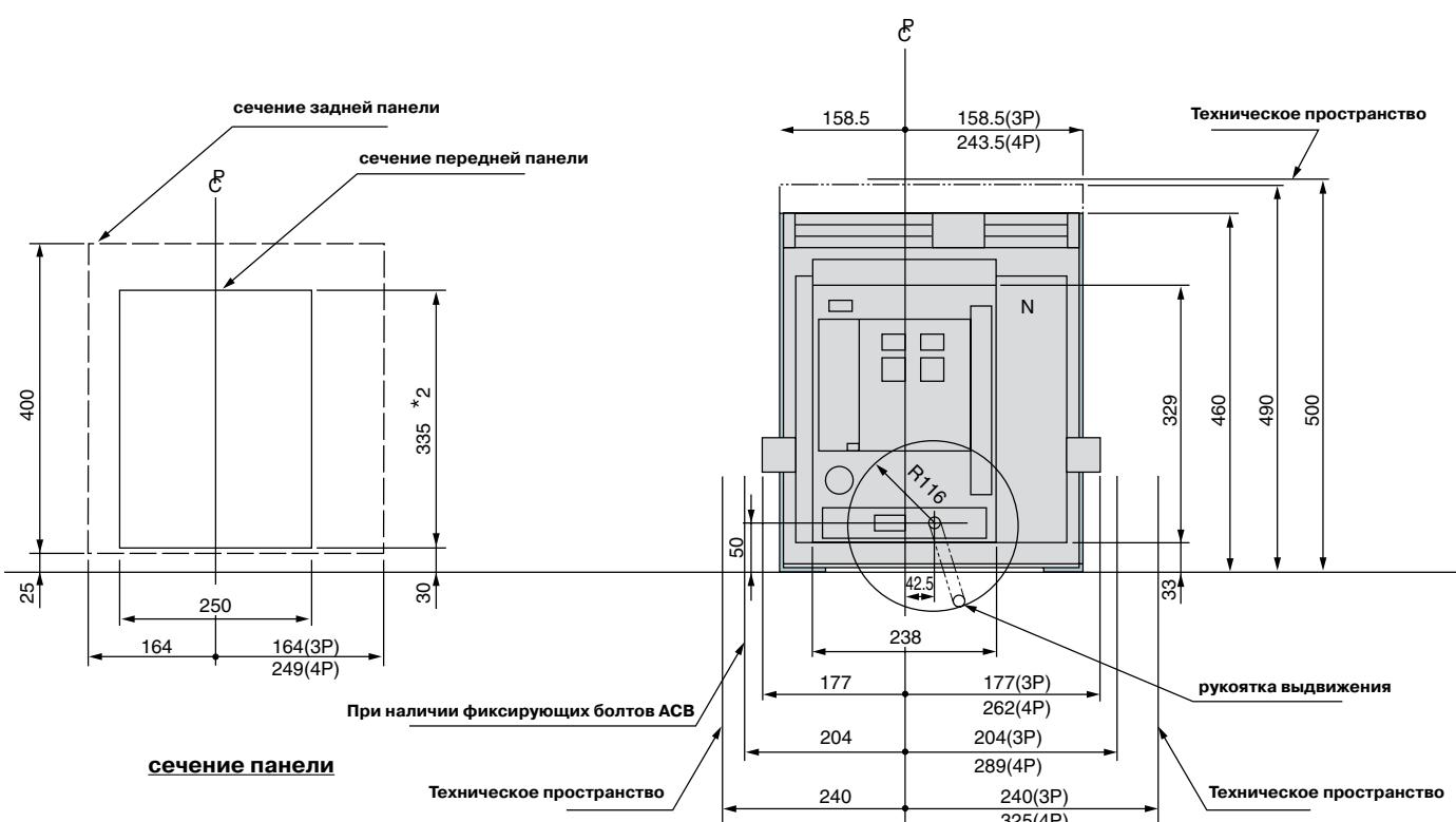
\*1 Токоведущие шины с соединительными болтами, должны быть удалены от элемента выдвижного механизма минимум на 7 мм.
