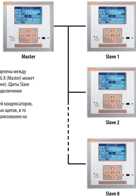
Система компенсации реактивной мощности "Master-Slave" с DCRG 8
