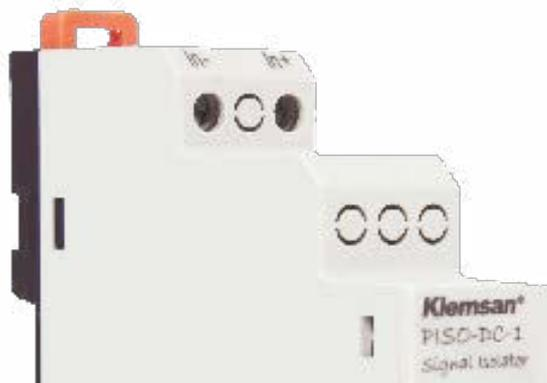
**PISO** – это устройство пассивной гальванической развязки, которое изолирует, трансформирует и объединяет значения аналоговых сигналов, получаемых от датчиков температуры, давления, уровня, веса и скорости. Для этого не требуется источник питания.
