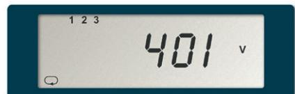
Рис.: Примеры индикации: Напряжение
