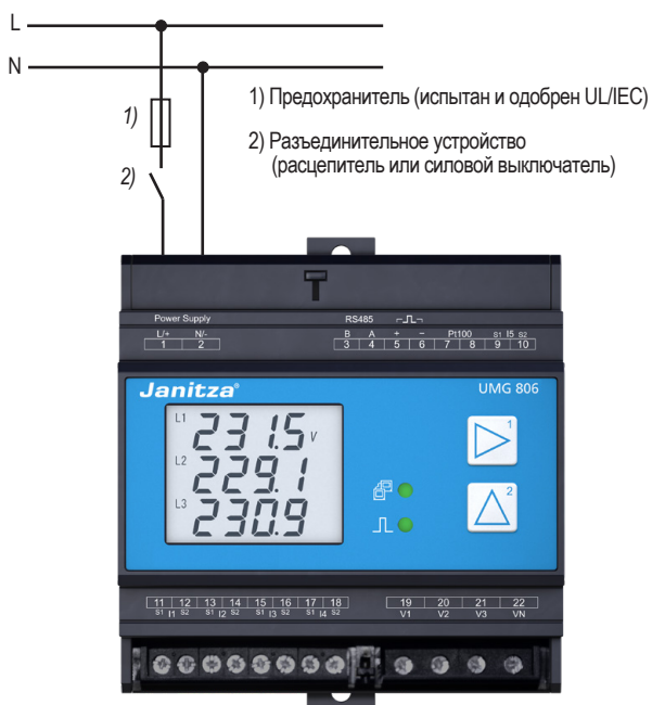
Рис.: подключение напряжения питания
