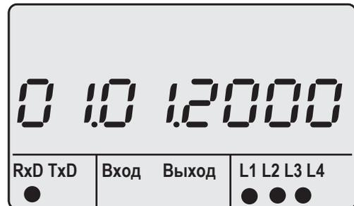
Рис. Индикация измеряемых значений с датой
