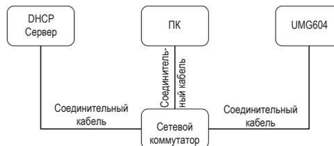
Рис. Пример подключения, UMG 604-PRO и ПК получают IP-адрес путем автоматического назначения от DHCP-сервера
