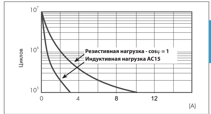
F 48 - Электрическая долговечность (AC) при ном. нагрузке, Типы 48.12/32
