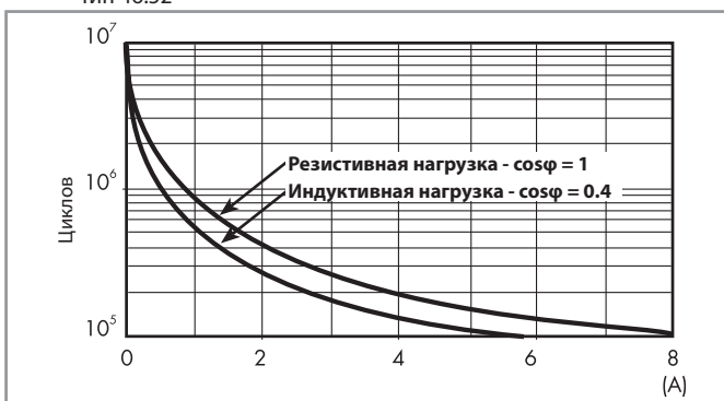
H 46 - Макс. отключающая способность DC1
