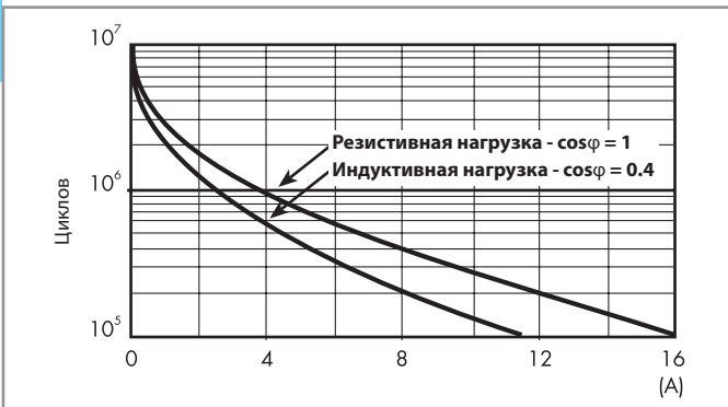
H 45 - Макс. отключающая способность DC1
