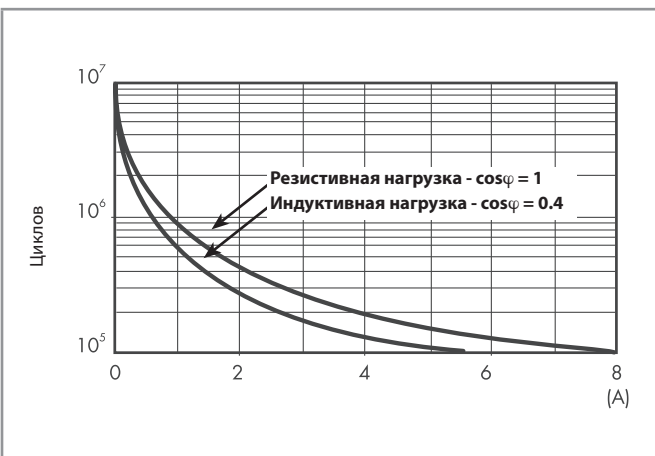
F 40.6 - Электрическая долговечность (АС) при ном. нагрузке Тип 40.62 (страница 5)
