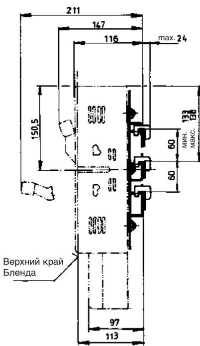
Простой переходник для системы сборных шин 60 мм
