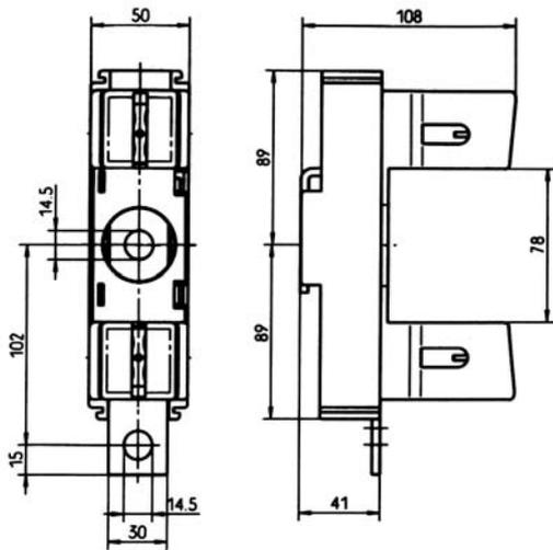
Типоразмер 3L Посадочная гайка M12, 425 A, 33039.0010/33040.0010
