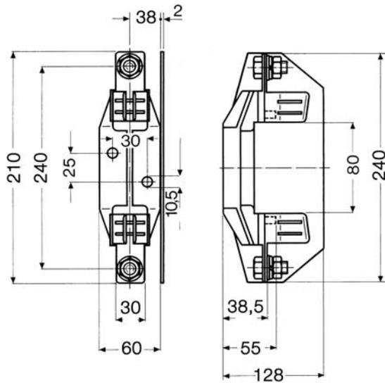
Нулевая шина Типоразмер 00
